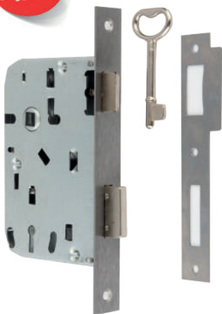
Cerradura de canto cuadrado de llavín en 68 entre ejes y 60 entrada. Material: Acero Inoxidable
